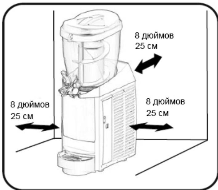
Установить машину на ровной поверхности таким образом, чтобы расстояние до любых боковых поверхностей составляло не менее 8 дюймов для циркуляции воздуха и во избежание перегрева. Оптимальная температура в помещении: 77-90 °F.
