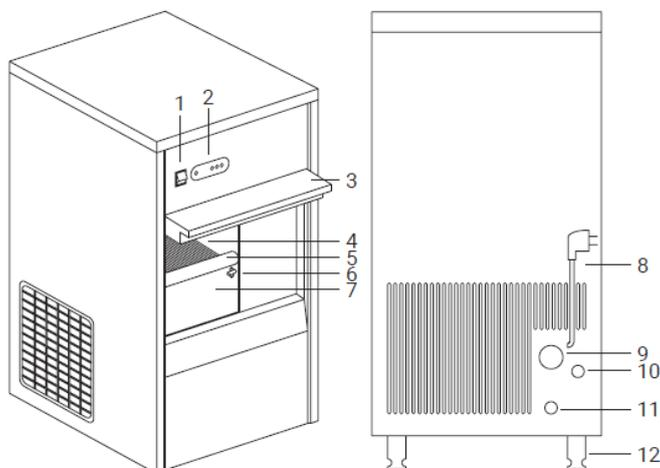
1. Сетевой выключатель «вкл/выкл»
