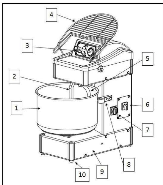
1) **ВАННА:** ёмкость, в которую загружаются различные ингредиенты для перемешивания, оснащена поворотным механизмом;
