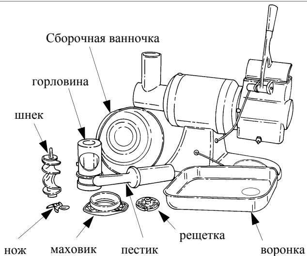
Рис. № 15-а – Разобранный TCG для очистки
