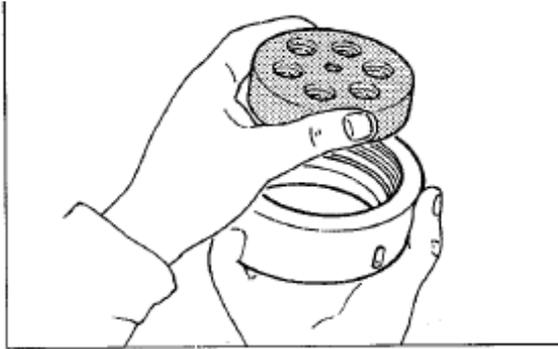
Поместите нужную пластину для теста внутрь кольцевой гайки и прикрутите её вместе с находящейся в ней пластиной к машине.
